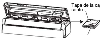
Pegatina del diagrama de cableado
